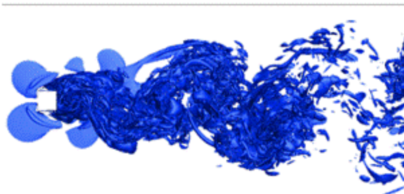
約5000万点格子で解析した側壁を有するRe1000の角柱周りの渦構造
