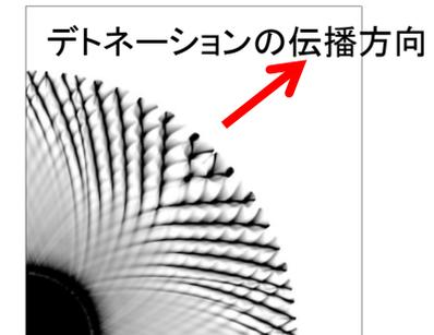
図1. 3次元直接起爆デトネーションの計算結果. 左: 瞬間圧力分布, 右: 底面の最大圧力履歴
