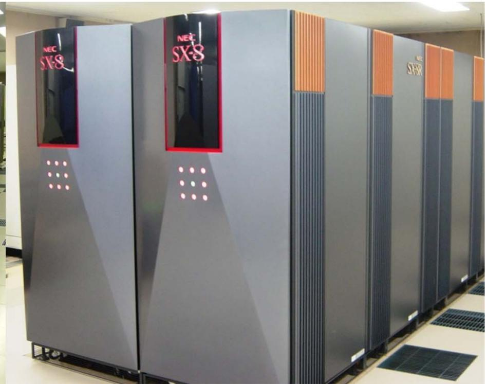
NEC製のベクトル型スーパーコンピュータ
