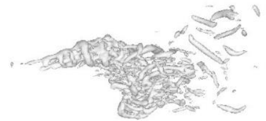
噴流出口を交互回転制御した自由噴流の渦構造
