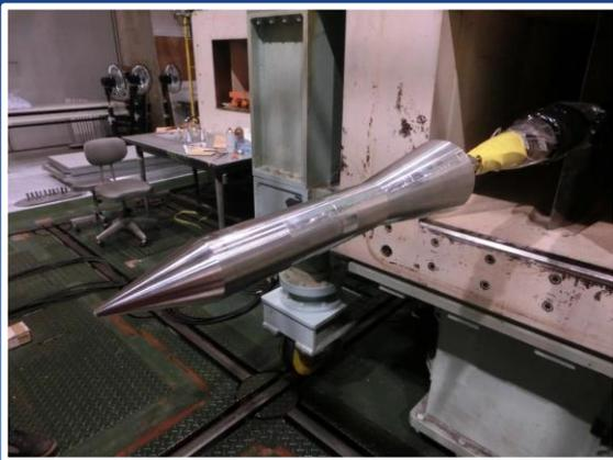
図1: 風洞実験模型
