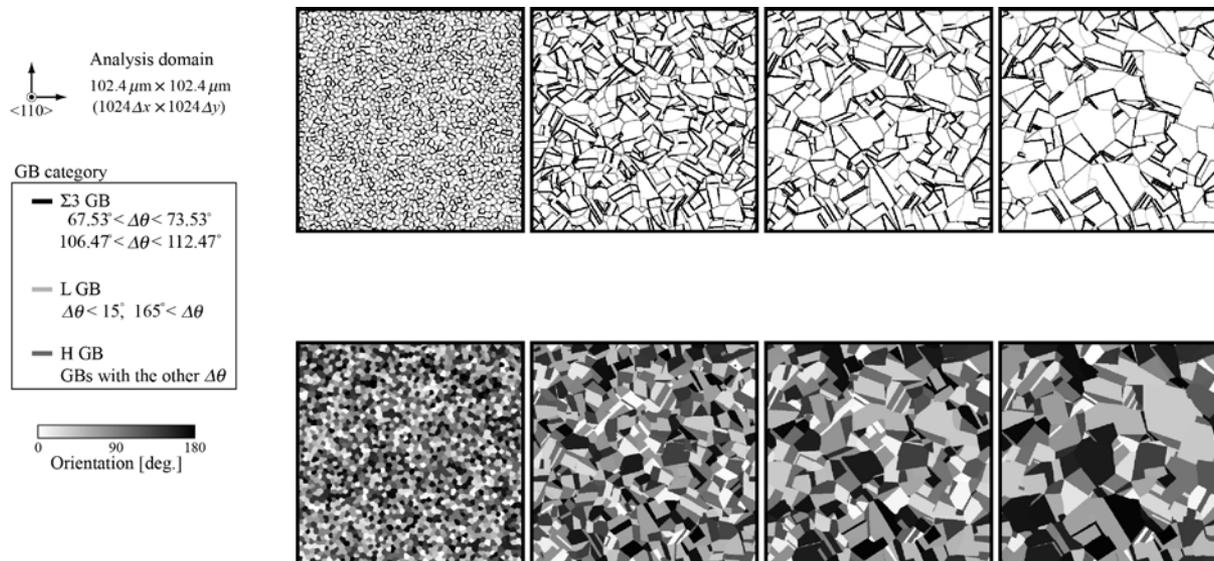
マルチフェーズフィールド法による粒成長シミュレーション
