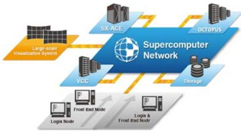
サイバーメディアセンターの保有・提供する大規模計算機システム (SX-ACE, VCC, OCTOPUS)、大規模可視化システムは、広帯域・低遅延なスーパーコンピュータネットワーク (CMC-SCinet : CMC-Supercomputer Network) で相互接続されています。
