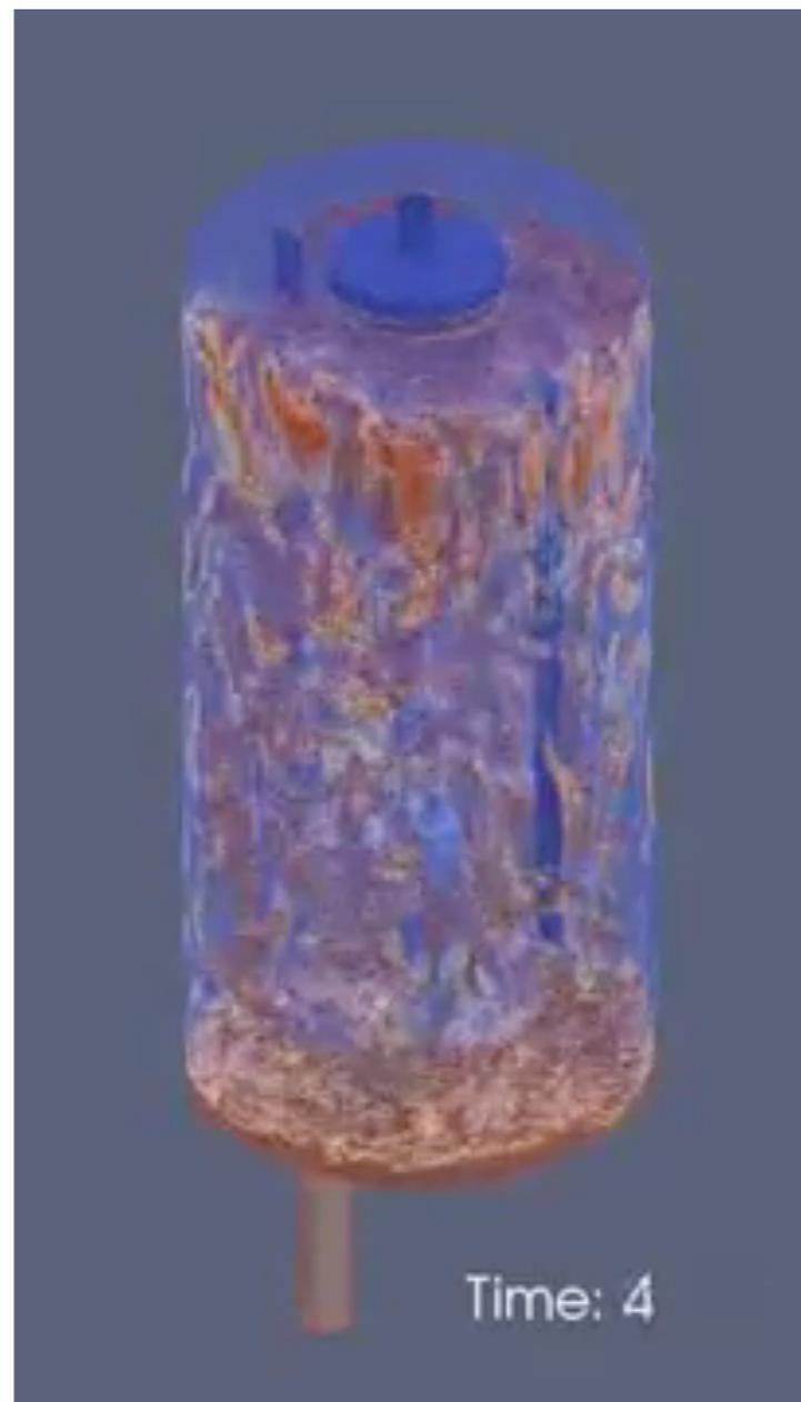
回転攪拌攪拌槽内の流れ
