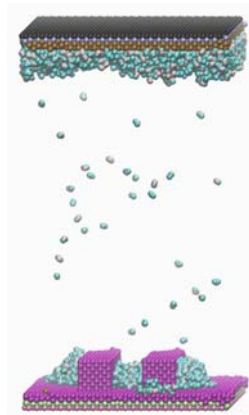
ナノ構造が凝縮過程に及ぼす影響 計算モデル (左) と計算結果 (右)
