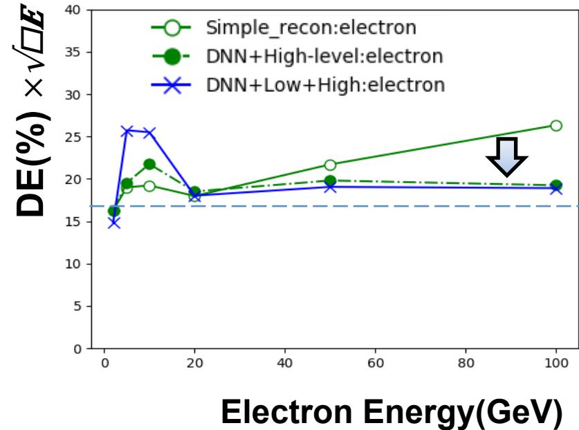
NNを用いてエネルギー較正を行うと、エネルギー分解能が向上
