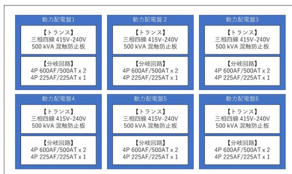
図 2 トランス構成、ブレーカ盤構成
