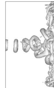
傾斜回転と脈動制御された衝突噴流の渦構造
