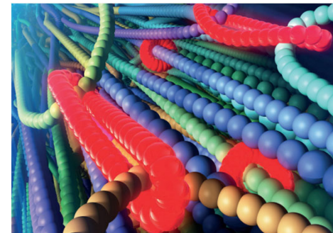
図 架橋ネットワークに添加した環状高分子のイメージ
