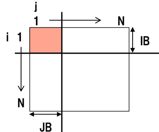
IBとJBのブロッキングを組み合わせ、IBを小さくしすぎないようにする。
