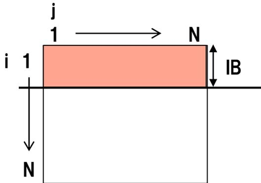
Nが大きい場合、キャッシュに載せるためにIBを小さくすると、最内がiとなるループのループ長が短くなる。
