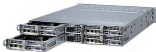
図 7 Xeon Phi ノード (Express5800/HR10c-M) の外観
