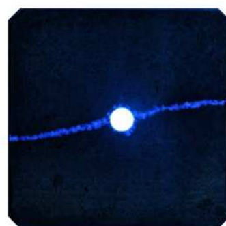
(b) 実験で観察された江持安山岩サンプル断面の亀裂形態
