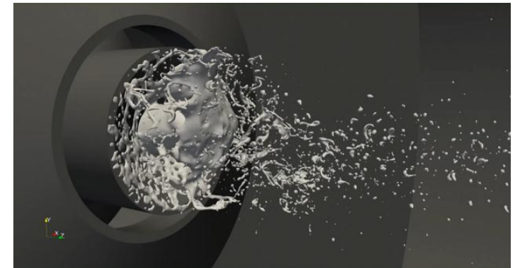
ノズル近傍の液体微粒化の様子
